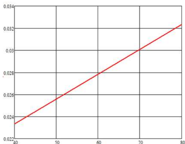
Рис.5. График зависимости шероховатости поверхности ситалла от времени обработки в плазме Ar.
