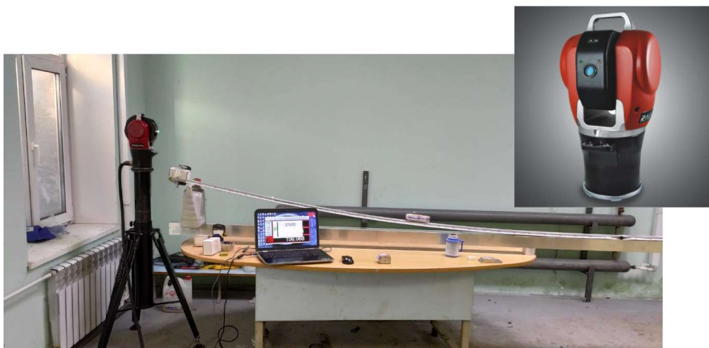
Рис.9. Лазерный трекер API Radian Pro и общий вид расстановки прибора во время измерений.
