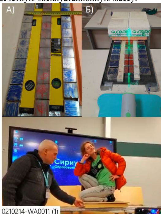
Рис.7. Пример трассы третьего уровня (масштабирование в основном по грузоподъёмности, позволяет обеспечить грузоподъёмность до 165 кг на единичную левитирующую опору, что, при наличии финансирования будет масштабировано до четырёхопорной платформы с проектной грузоподъёмностью уже более чем 600 кг).
