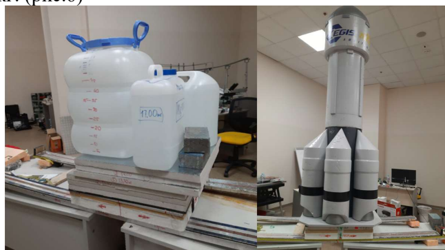
Рис.6. Пример трассы второго уровня (масштабирование в основном по грузоподъёмности, при минимально репрезентативной длине трассы).
