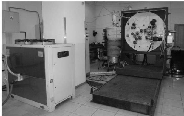
Рис.4. Установка вакуумной металлизации углеродной тканевой ленты.
