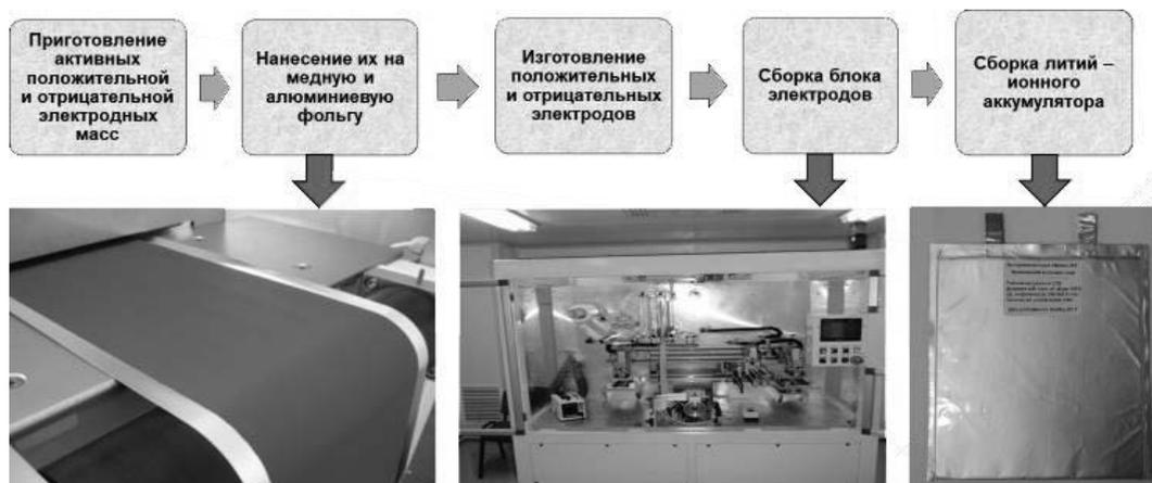
Рис.1. Перечень процессов производства ХИТ и СКС по толстопленочной технологии [8].
