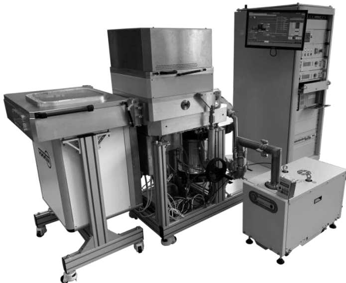
Рис. 1. Установка плазмохимического осаждения диэлектрических слоев «Изофаз ТМ 300».
