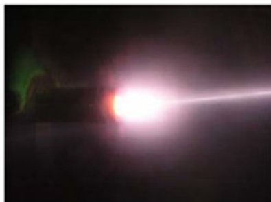
Рис.3. Плазма вблизи поверхности керамической мишени: мишень \text{LaB}_6 , плазмообразующий газ – гелий, P_m = 0,5 Торр, T \approx 1400\text{K} , U \approx 250\text{В} .
