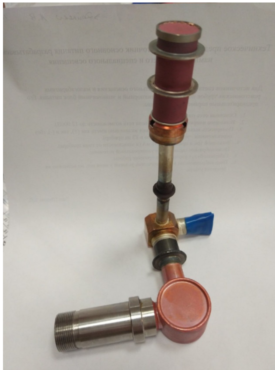
Рис.2. Вид рабочего прототипа рентгеновской трубки с автокатодом.
