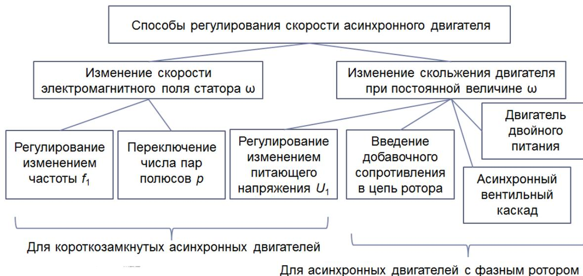
Рис. 5. Способы регулирования скорости асинхронного двигателя.
