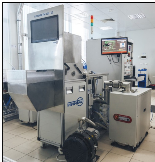
Рис. 1. Установка глубокого анизотропного травления ПЛАЗМА ТМ 200-02К.
