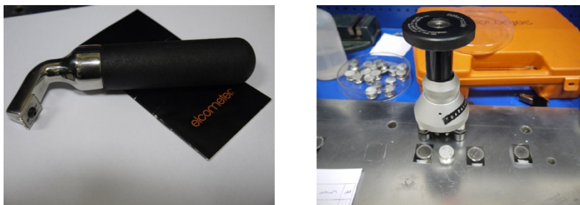
Рис. 2. Приборы для контроля адгезии (слева для метода сетчатых надрезов, справа для метода отрыва).
