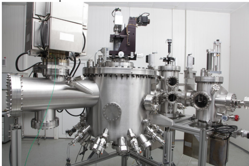
Рис. 2. Ростовый реактор системы МЛЭ STE35 нового поколения.
